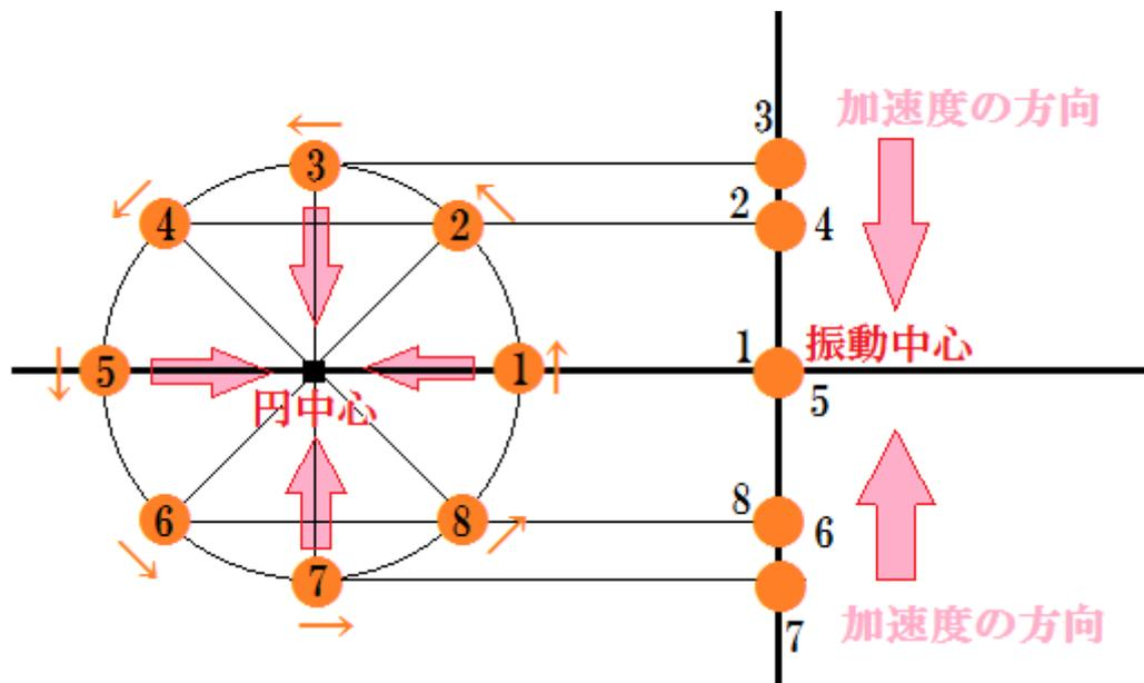
上の図は水平面上を等速円運動するおもりの運動と、その左からの正射影を右側にあるスクリーンに表した図である。おもりが1から8へ回転すると、スクリーン上にも1から8へ影が移動する。どちらも中心に向かって加速度運動していることが分かる。古典物理学者はそのことに注目し、「**単振動する物体の軌道は円運動の正射影と一致する**」と主張した。
