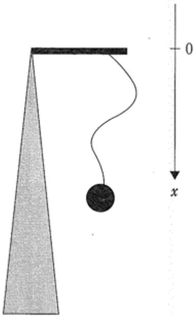
バンジージャンプの仕組みを、簡単なモデルによって考えてみよう。図のように塔の頂点の高さから飛び降りる人間を、質量 $M$ の小物体と考える。この小物体に自然長 $L$ のゴムロープの一端が留められており、他端は塔に固定されているとする。塔の高さは $L$ に比べて十分大きいとする。使用するゴムロープは張力が働かないときはゆるむが、自然長 $L$ より伸びて張力が働く時にはばね定数 $k$ のばねとして働く。塔の頂点の位置を原点として $x$ 座標を考え、下向きに正にとる。重力加速度の大きさを $g$ とし、空気抵抗やゴムロープの質量は無視する。人間は時刻 $t = 0$ に初速度ゼロで真下に飛び降りたとして、以下の問いに答えよ。
